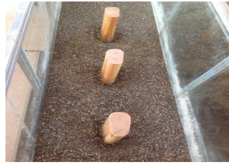
(d) Scour bed around the group of bridge piers 8-10 cm.
