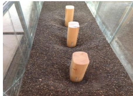
(d) Scour bed around the group of bridge piers 8-10 cm.
